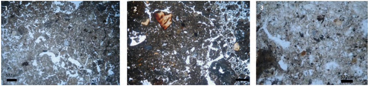
Fig. 6 – Clichés de lames minces représentatives des trois faciès de terre à bâtir de St 10. 1 : faciès GGB, limons carbonatés de la « havara » ; 2 : faciès JBJ, limons carbonatés à particules charbonneuses et esquilles d'os brûlées ; 3 : faciès BNA, limons carbonatés et phytolithes associés à d'abondants débris végétaux carbonisés (MPOL [LPNA]).
