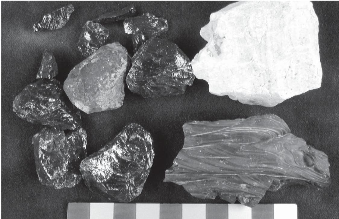
**Fig. 2** – Échantillons représentatifs de scories de réduction de cuivre, vitreuses, de couleur noire et rouge, provenant de différentes localités de Majorque, et une pièce de malachite avec du calcaire comme roche-mère. Barre d'échelle : 10 cm.
