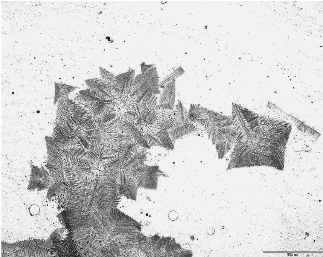
Fig. 4 – Échantillon E-3/3. Cristaux capillaires de géhlénite dans une roche-mère cristalline composée de  $\text{SiO}_2 - \text{CaO} - \text{Al}_2\text{O}_3$ . Lumière transmise. Barre d'échelle: 500  $\mu$ .
