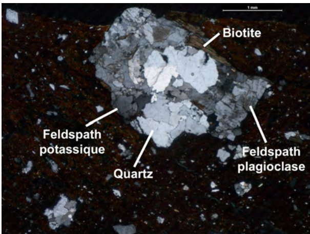
Fig. 4 – Micrographie d'une lame mince de la céramique de Bordustard en lumière polarisée (LP).
