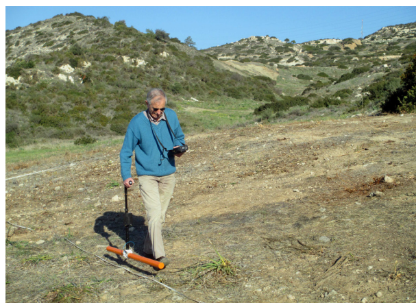
Fig. 4 – Prospection électromagnétique avec un CMD Mini-Explorer (Gf Instruments; cliché J.-D. Vigne).
