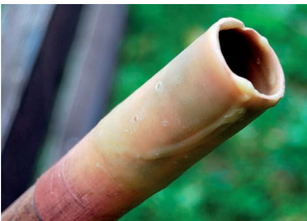
Fig. 6 – Foret tubulaire expérimental en cuivre enduit de cire. Fig. 6 – Experimental tubular drill in copper coated with wax.
