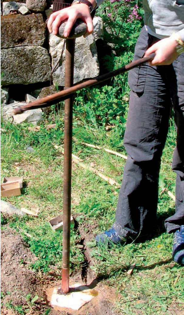
Fig. 5 – Forage tubulaire expérimental d'un bloc de marbre avec un foret à archet, un tube en cuivre, des abrasifs et de l'eau. fig. 5 – Drilling tubular experimental of a block of marble with a bow drill, copper tubing, abrasive and water.
