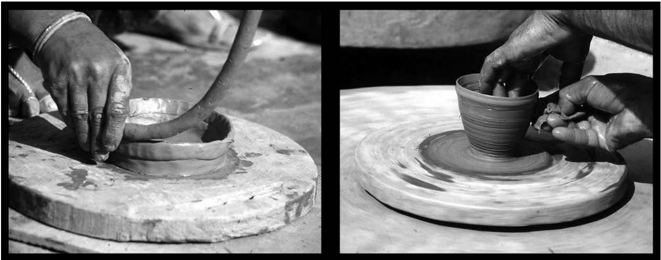
Fig. 1 – Les techniques du colombin (sans énergie cinétique rotative) et du colombin au tour (avec énergie cinétique rotative). Fig. 1 – The coiling technique (without rotary kinetic energy) and the wheel coiling technique (with rotary kinetic energy)
