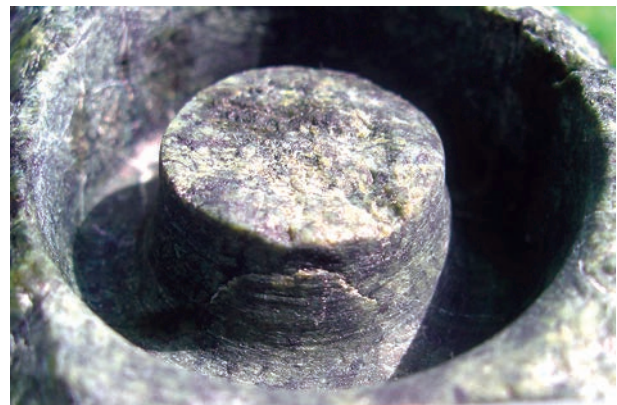
Fig. 8 – Exemple de carotte de forage expérimental se formant au centre du forage tubulaire. Fig. 8 – Example of experimental drilling core forming the center of the drill pipe.
