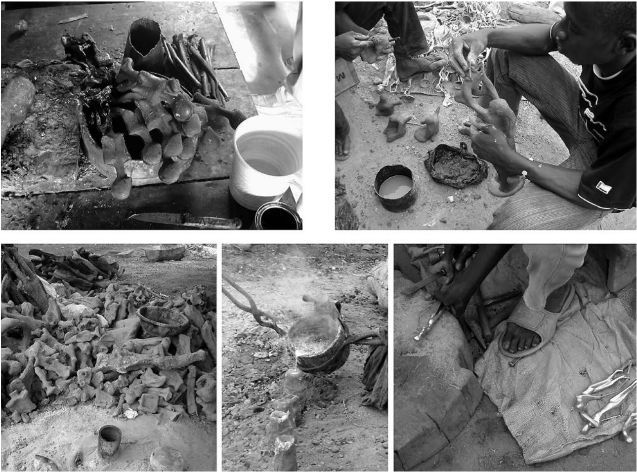
Fig. 3 – Chaîne opératoire d'une fonte pleine à la cire perdue, atelier de bronze du village artisanal de Ouagadougou (Burkina Faso), mars 2008 (© L. Garenne-Marot). (a) Travail de la cire; (b) confection des moules de coulée; (c) étuvage des moules autour d'un foyer; (d) coulée du métal; (e) statuettes en cours de finition.
