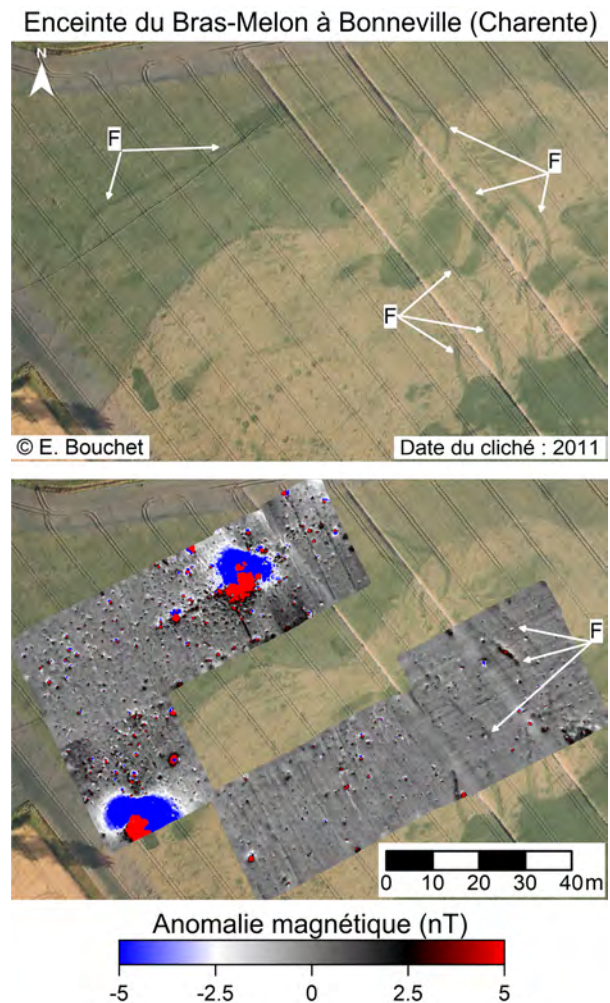
Fig. 7 – Bras Melon à Bonneville (Charente). Photographie aérienne de l'enceinte fossoyée prise en 2011 par Éric Bouchet. Carte des anomalies magnétiques de l'enceinte fossoyée (prospection géomagnétique réalisée en 2018 : G. Bruniaux ; V. Legrand). « F » sont les fossés discontinus.
