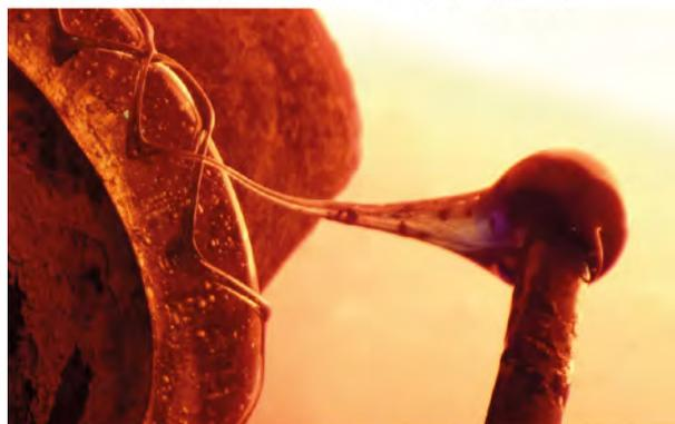
c. Pose d'un décor de filets en 8 à l'aide d'un ferret
