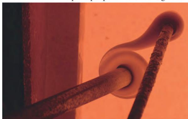
b. Enroulement du verre autour d'un ferret
