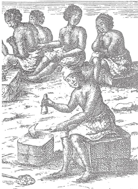
**Fig. 10 – Métallurgiste africain travaillant avec une enclume et un marteau en pierre (d'après Calegari et Pezzoli, 1986, p. 14, cité par Armbruster, 2008, p. 21, fig. 8).**
